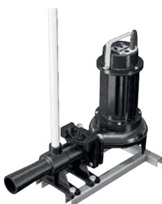
**Aeratori sommersi** di tipo Venturi, che permettono un'efficace azione combinata di miscelazione ed aerazione, particolarmente adatti per vasche di omogeneizzazione e stoccaggio di prima pioggia
